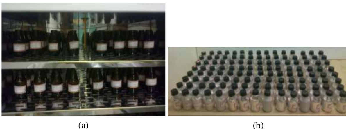
**Figura 13.** (a) Degradação acelerada em estufa de amostras de óleos e biodieseis. (b) Amostras termodegradadas e prontas para armazenamento em geladeira.
